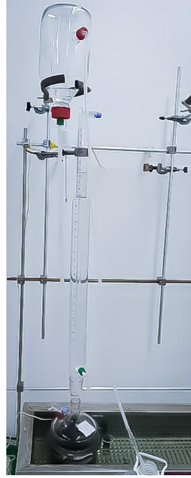
Şekil 2: İnkübasyon Testi İle Gaz Üretimi (GS21)
