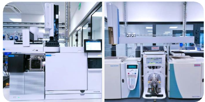
Şekil 4: PBDD/F analizlerinde kullanılan GC-MS/MS ve GC-HRMS cihazları
